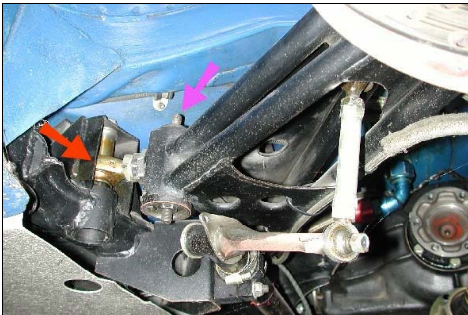
Рис. 4. Конструктивное исполнение опоры рычага.
