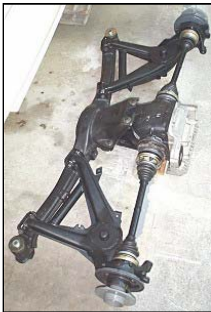
Рис. 1. Задняя подвеска автомобиля BMW M3 E30
